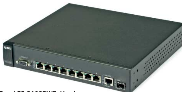
Zyxel ES-2108PWR: Hardware-Monitor, zahlreiche Konfigurations- und Überwachungsoptionen, aber nur wenige für PoE
