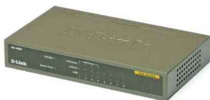
D-Link DES-1008P: nicht konfigurierbar, geringe Leerlaufleistungsaufnahme, PoE-Defekte
