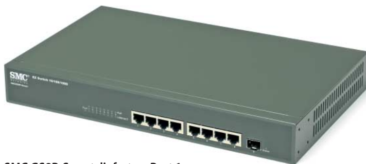
SMC GS8P-Smart: liefert an Port 1 bis zu 25 W, weitgehend konfigurierbar, aber nicht für QoS, dadurch Paketverluste
