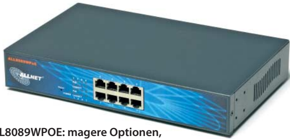
Allnet ALL8089WPOE: magere Optionen, verstand sich nicht mit dem PoE-Auskoppler, Frame-Verlust im QoS-Szenario, weil nur zwei Queues
